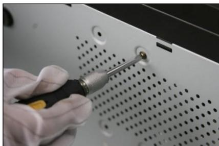
5、盖好机箱盖板，并将盖板用螺丝固定。
