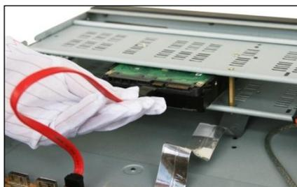
5、将电源线连接在硬盘上。
