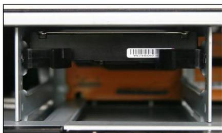
6、重复以上步骤，完成其他硬盘安装后，合上机箱前挡板，并用钥匙将其锁定。
