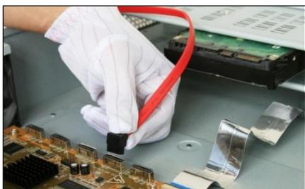
4、硬盘数据线的另一端连接在硬盘上。
