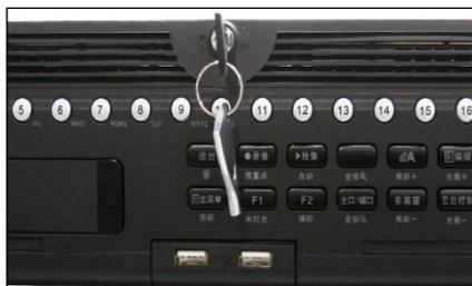
3、参照图示方向按下面板两侧锁扣，打开前面板。
