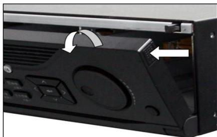
4、参照图示方向，将硬盘缓慢插入。
